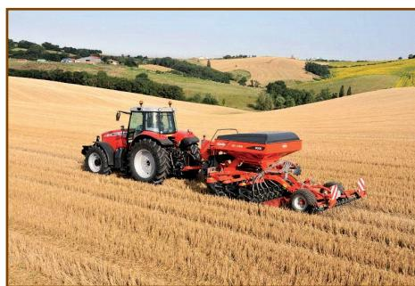
Obr. 3.8 Výsev kukuřice bezorebným secím strojem do rostlinných zbytků předplodiny
