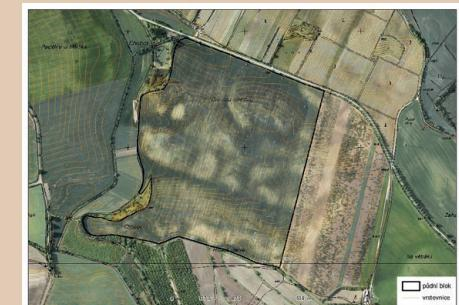
Obr. 4.10 Ortofotosnímek půdního bloku, který poukazuje na poškození půdy vodní erozí (vybělená místa)
