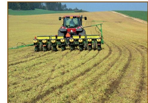
Obr. 3.10 Kukurice setá bezorebným secím strojem do mulče žita setého (Sedmihorky, foto: ZEA Sedmihorky)
