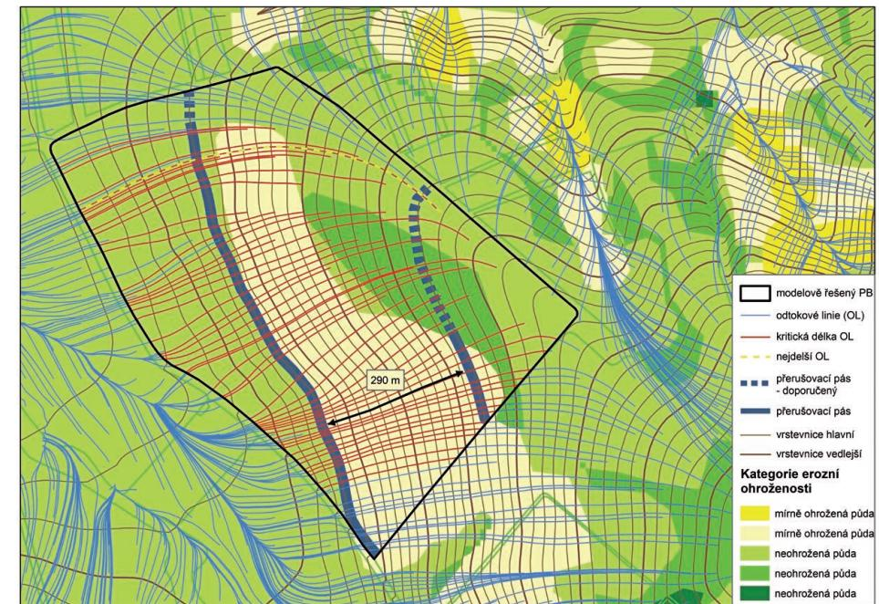
Obr. 2.5 Přerušovací pásy na PB/DPB se sklonitostí do 3° (přerušované zobrazeno doporučené opatření)
